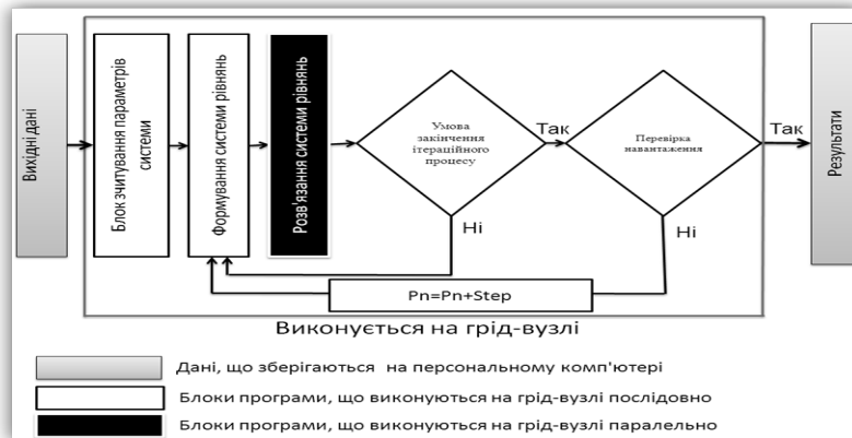
Рис. 2. Технологічна схема розв'язування задачі розрахунку напружено-деформованого і граничного станів трубопроводу
